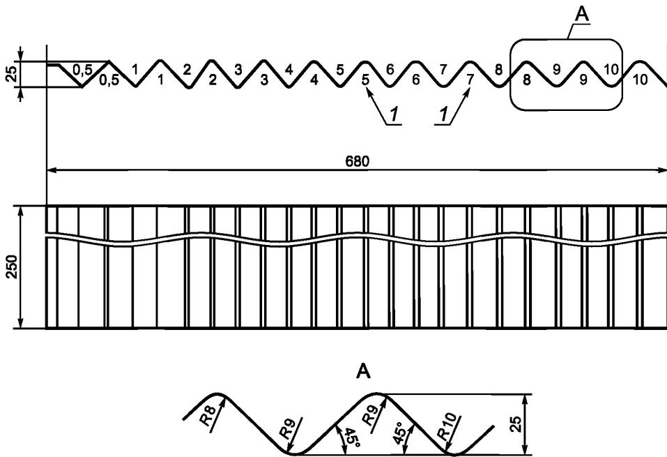
1 — изгибы (все изгибы с углом 90°; с наклонными участками под углом 45° к горизонтали)
