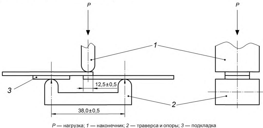
Рисунок 2 — Схема проведения испытаний
