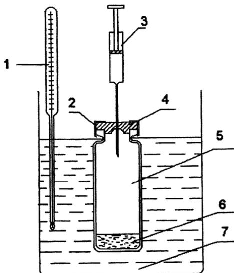
**Рис. 1.** Установка для создания равновесной паровой фазы.
