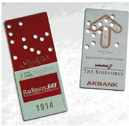
Рисунок 4.2 – Идентификатор с перфорационным кодированием, выполненный в виде карты
