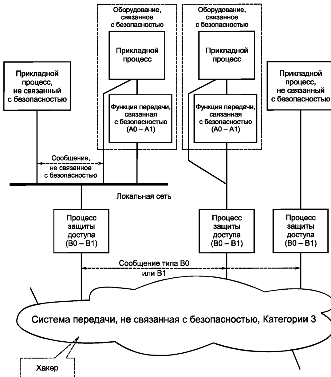
Рисунок С.7 — Коммуникация между связанными и не связанными с безопасностью приложениями
