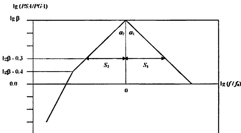
$S_1$  – высокочастотная часть спектра;  $S_2$  – низкочастотная часть спектра;  $S = S_1 + S_2$  – логарифмическая ширина спектра;  $f_0$  – преобладающая частота колебаний;  $PGA$  – пиковое ускорение грунта;  $PSA$  – спектральная амплитуда;  $\beta$  – коэффициент динамического усиления
