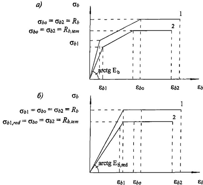
а – трехлинейная; б – двухлинейная; 1 – при 20 °С; 2 – при нагреве
