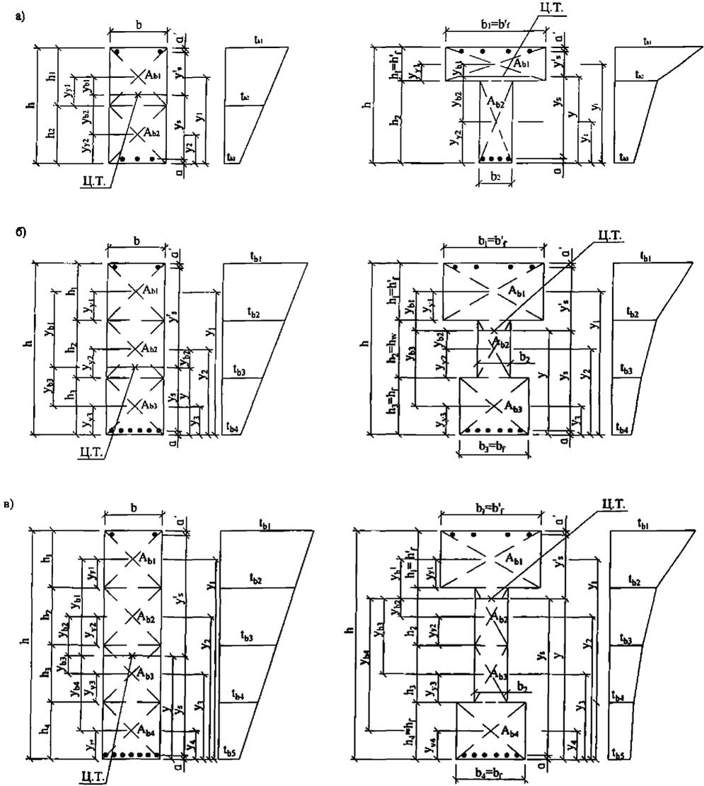
$a$  – на две части;  $b$  – на три части;  $v$  – на четыре части; Ц.Т. – центр тяжести приведенного сечения;  $t_{b1}, t_{b2}, \dots, t_{bi}$  – наибольшая температура бетона 1-й, 2-й, ...  $i$ -й частей сечения
