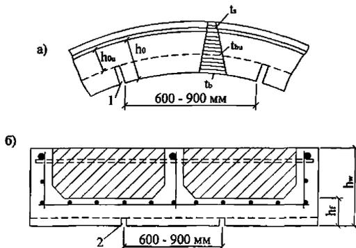
*a* – компенсационные; *b* – усадочные; *I* – компенсационный шов шириной 2–5 мм;
