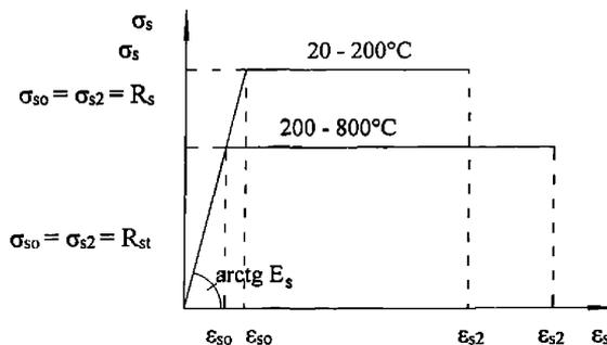
**Рисунок 5.2 - Расчетная двухлинейная диаграмма растянутой арматуры**
