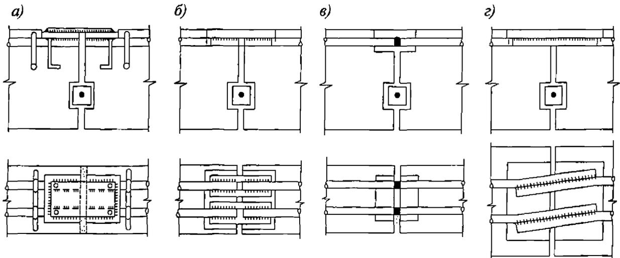
*a* – нахлесточное соединение с металлической накладкой из листовой стали; *б* – стыковое соединение по ГОСТ 10222; *в* – стыковое соединение по ГОСТ 14098; *з* – нахлесточное соединение
