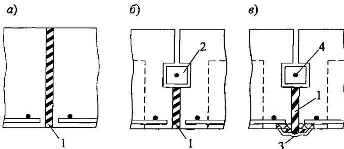
а – шов, заполненный шнуровым асбестом; б – то же, с бетонным бруском; в – то же, с металлическим компенсатором; 1 – шнуровой асбест, смоченный в глиняном растворе; 2 – бетонный брусок; 3 – компенсатор; 4 – стальной стержень диаметром 6 мм
