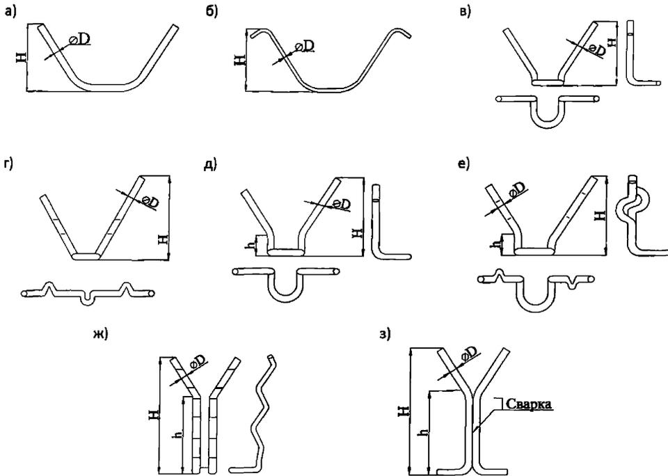
а, б, в, г – анкеры для однослойного бетона; д, е, ж, з – анкеры для многослойного бетона
