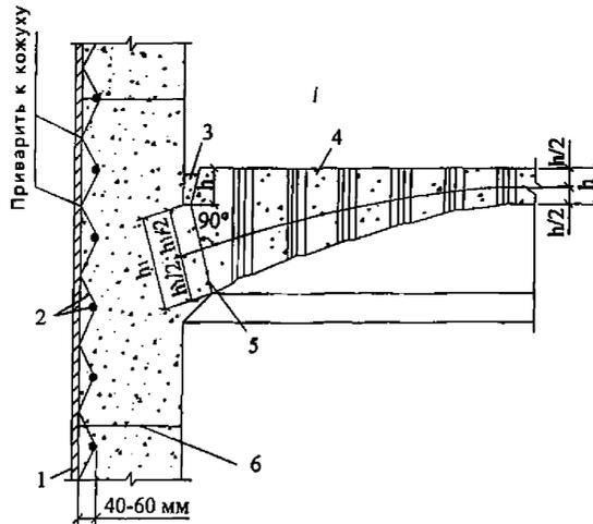
1 – кожух; 2 – сетка из проволоки диаметром до 6 мм, приваренная к кожуху; 3 – компенсационный шов толщиной 20 – 40 мм, заполненный легко деформируемым материалом; 4 – бетонный купол; 5 – пята купола; 6 – шов бетонирования
