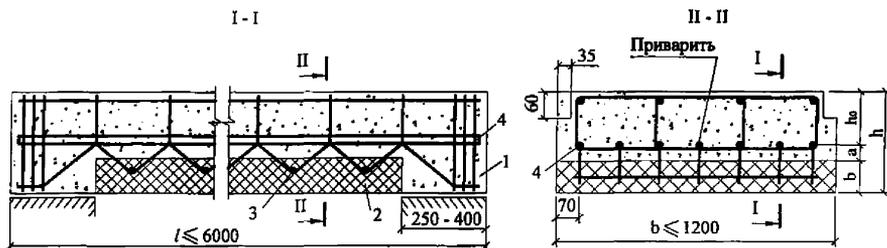
*I* – тяжелый жаростойкий бетон; *2* – теплоизоляционный слой из легкого жаростойкого бетона;
