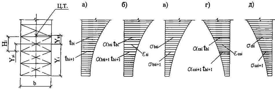
*a* – температуры бетона; *b* – деформации удлинения от нагрева; *в* – напряжения в бетоне от нагрева; *г* – деформации укорочения от остывания; *д* – напряжения в бетоне от остывания при нелинейном изменении температур по высоте бетонного сечения элементов; Ц.Т. – центр тяжести приведенного сечения
