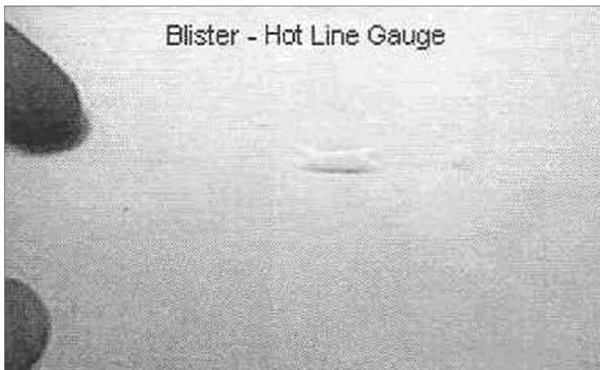
Рисунок А.77 — Пузыри литейного происхождения
