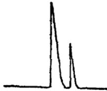
в) картина на экране дефектоскопа при включенной задержке.
