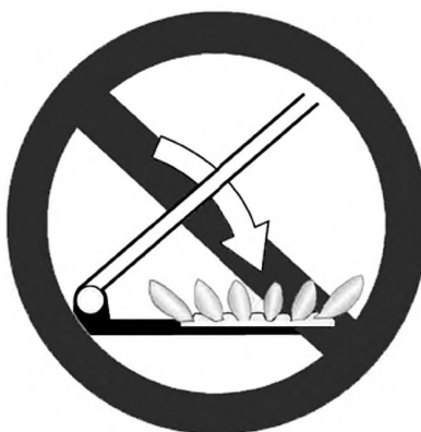
Рисунок F.1 — Предупреждающий знак «Не закрывать крышку при работающих горелках»
