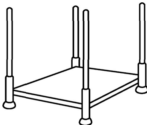
Рисунок А.8 — Стоечный поддон с несъемными стойками
