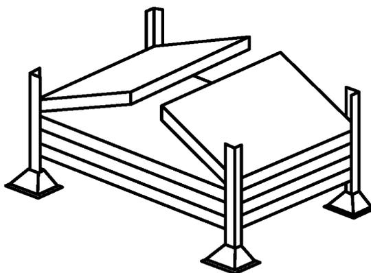
Рисунок А.5 — Складной ящичный поддон с цельными стенками
