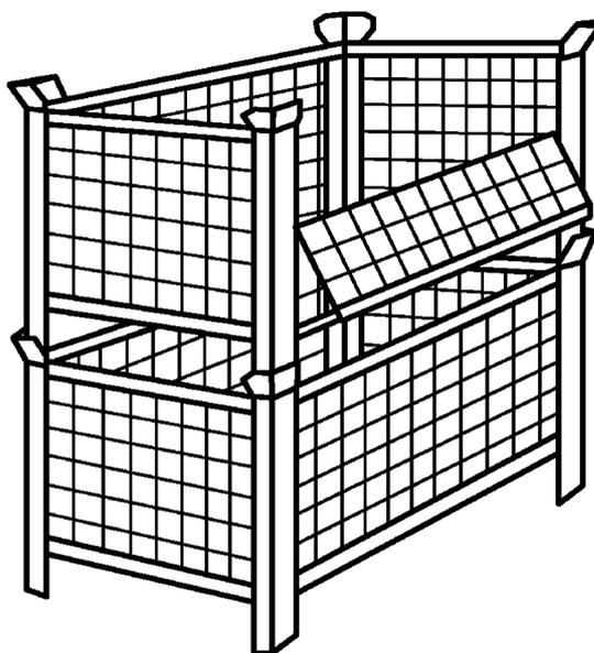
Рисунок А.2 — Ящичный поддон с сетчатыми стенками
