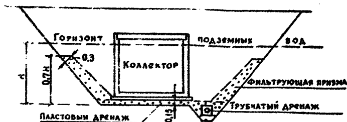
Рис. II. Схема сопровождающего дренажа коллектора.
