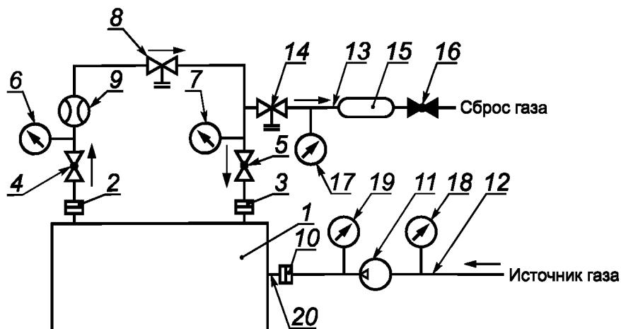
— шаровой кран (открыт); — шаровой кран (закрыт); — быстроразъемное соединение; — компрессор;
