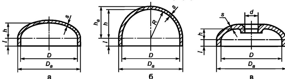
а — глухое эллиптическое днище; б — глухое полусферическое днище;
