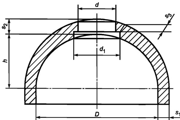
Рисунок 3 — Лазовое отверстие в выпуклом днище переменной толщины
