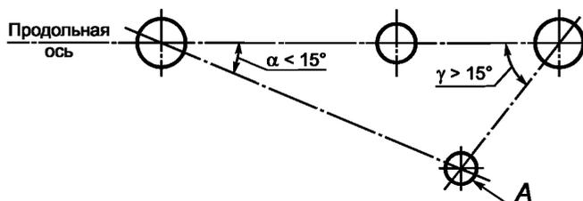
Отверстие А в направлении слева направо входит в ряд отверстий, так как угол  $\alpha < 15^\circ$ , и расчет допускается производить без учета угла как для продольного ряда.
