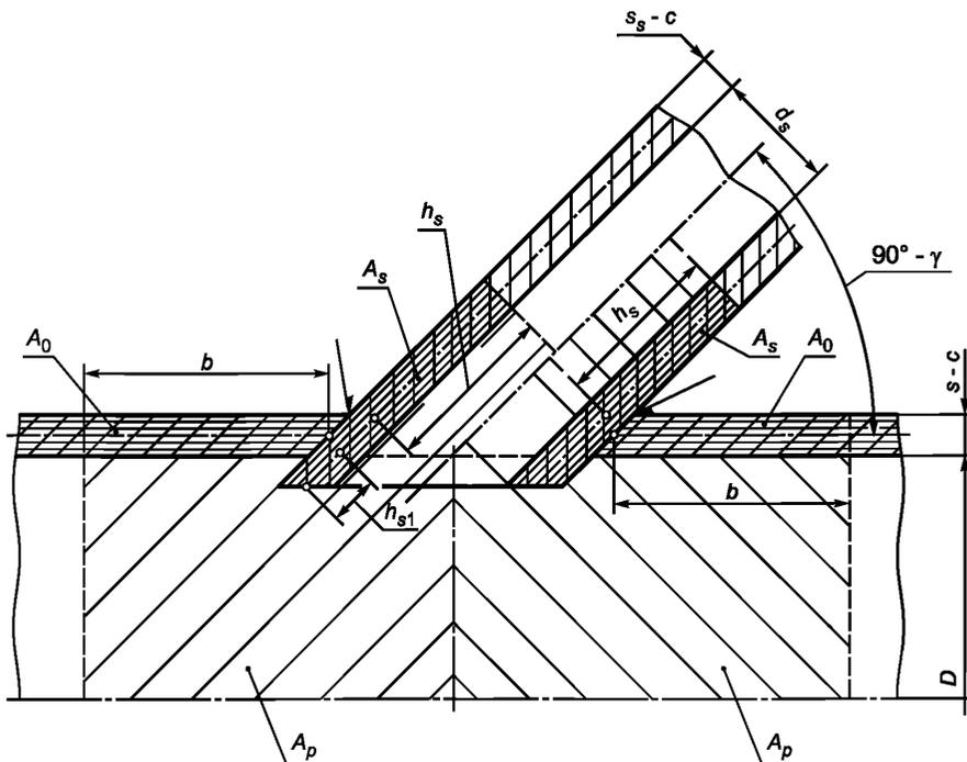
Рисунок 20 — Схема детали с наклонным штуцером
