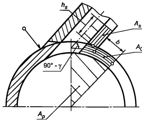
Рисунок 21 — Схема детали с тангенциальным вводом штуцера
