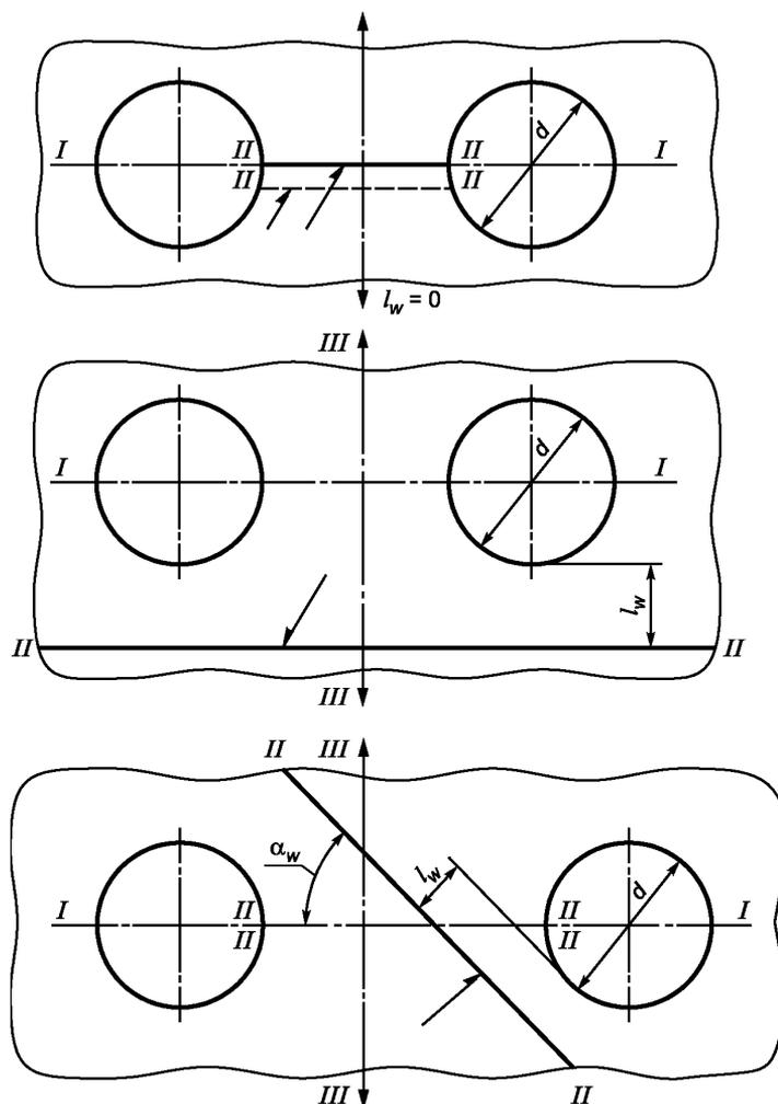
I—I — расчетное направление (для цилиндрической детали при расчете на внутреннее давление — продольная ось);
