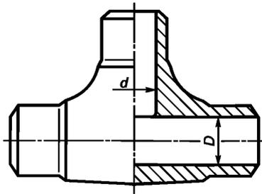
Рисунок 22 — Схема кованого тройника
