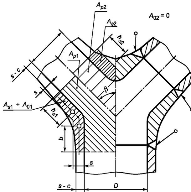
Рисунок 24 — Схема развилки
