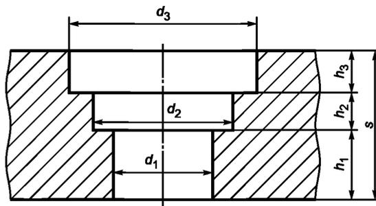
Рисунок 12 — Отверстие с различными диаметрами по толщине стенки
