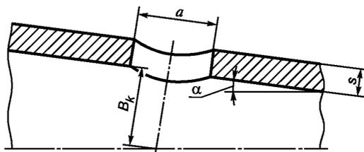
Рисунок 19 — Коническая деталь
