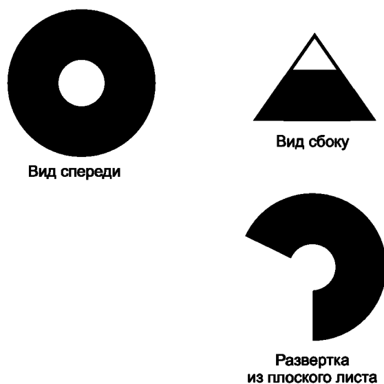
Рисунок С.1 — Шаблон усеченного конуса для вуалирования яркого света
