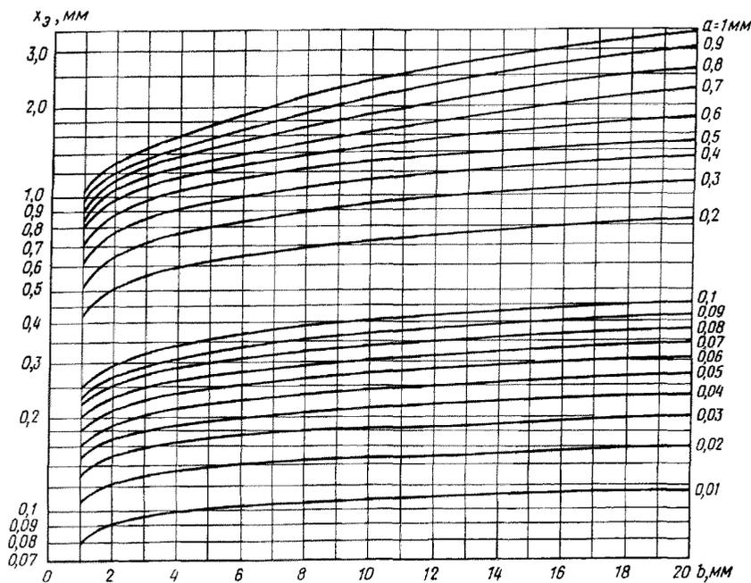
Рисунок Б.1 — Номограмма для определения эквивалентного размера протяженных объектов различения при расстояниях от глаза до объекта до 500 мм
