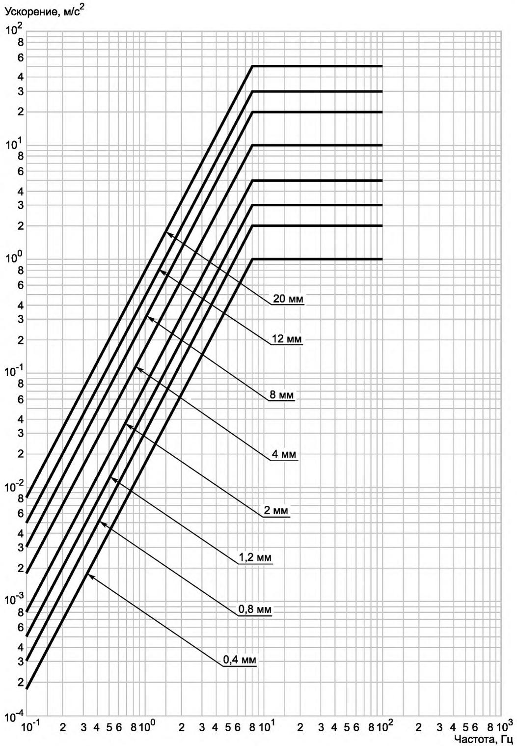
Рисунок 8 — Рекомендуемые уровни вибрации при частоте перехода 8 Гц
