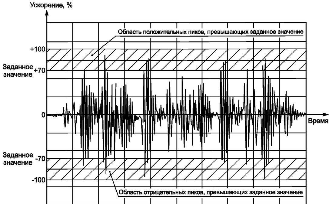
Рисунок 5 — Типичный отклик осциллятора на воспроизведенную акселерограмму процесса
