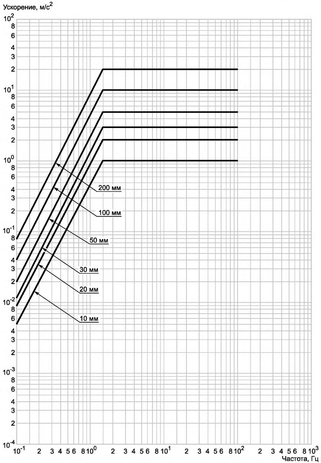
Рисунок 7 — Рекомендуемые уровни вибрации при частоте перехода 1,6 Гц
