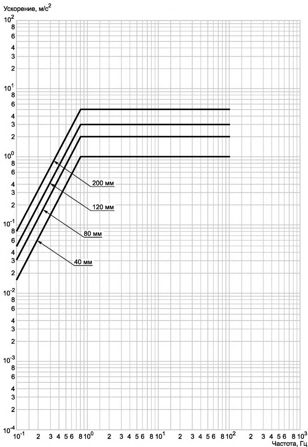
Рисунок 6 — Рекомендуемые уровни вибрации при частоте перехода 0,6 Гц
