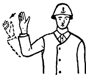
Рис. 6. Правая рука полусогнута в локте перед собой, ладонью в сторону движения груза. Рукой до локтя производить движения в сторону необходимого перемещения груза
