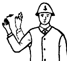
Рис. 6. Правая рука полусогнута в локте перед собой, ладонью в сторону движения груза. Рукой до локтя производить движения в сторону необходимого перемещения груза
