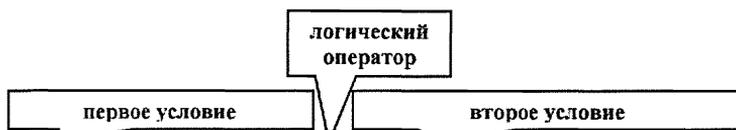
1. Если три ГЦНА находятся в работе **И** мощность реактора больше 69 %  $N_{ном.}$ , то уменьшить мощность реактора с помощью ключа ПЗ-1.
