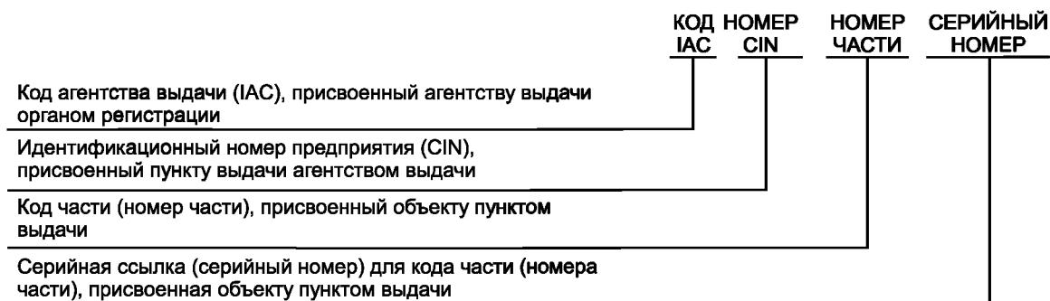
Рисунок С.2 — Стока, использующая серийное расширение
