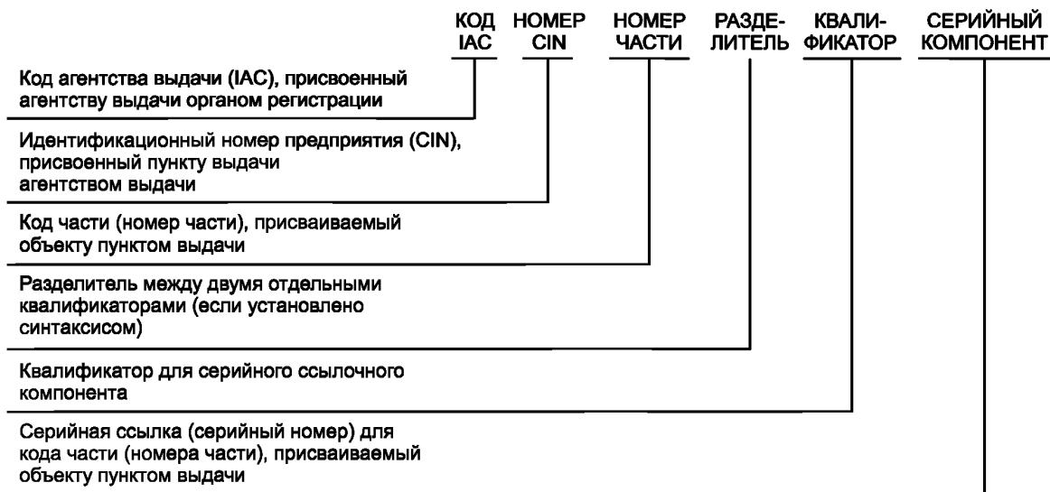
Рисунок С.3 — Стока, использующая серийный компонент с разделением
