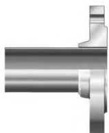
Рисунок 10 - Фланцевое соединение с фланцем для пайки из литейной бронзы
