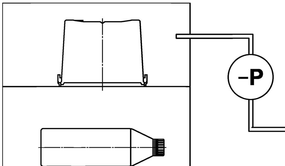
Рисунок 1 — Контроль герметичности упаковки в вакуумной камере
