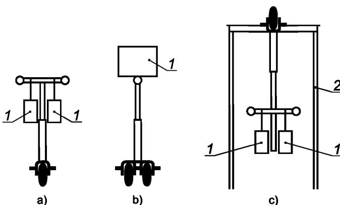
1 — испытательный груз; 2 — испытательный стол
