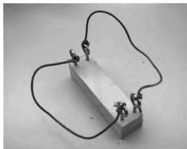
Рисунок 42 — Пример испытательного блока со шнурами
