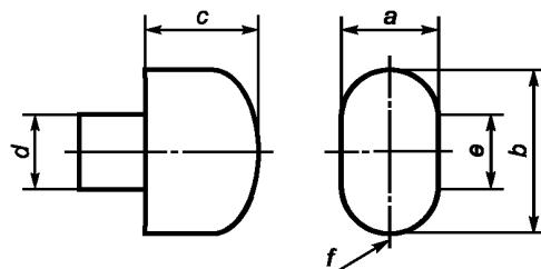
a — 96 мм; b — 124 мм; c — 112 мм; d — 42 мм; e — 28 мм; f — главная ось щупа
