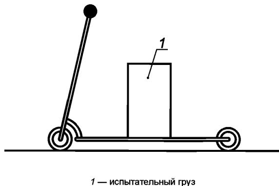
Рисунок 28 — Испытание статической прочности у игрушечных самокатов
