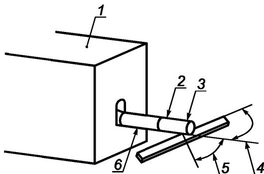
1 — переносное или стационарное устройство, воздействующее на шпиндель с определенным усилием и обеспечивающее его поворот; 2 — усилие, действующее на ось шпинделя,  $(6,0 \pm 0,5)$  Н; 3 — самоклеящаяся лента, обернутая вокруг шпинделя в один слой; 4 — направление испытательного усилия по отношению к шпинделю —  $(90^\circ \pm 5^\circ)$ ; 5 — диапазон регулирования угла для поиска неблагоприятного положения кромки; 6 — шпиндель, осуществляющий при испытании полный оборот
