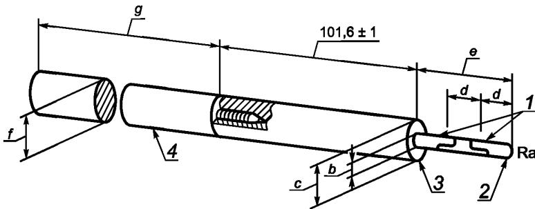
1 — шарниры; 2 — закругление в форме полусфера радиусом ( $R_a$ ); 3 — кольцо; 4 — удлинитель
