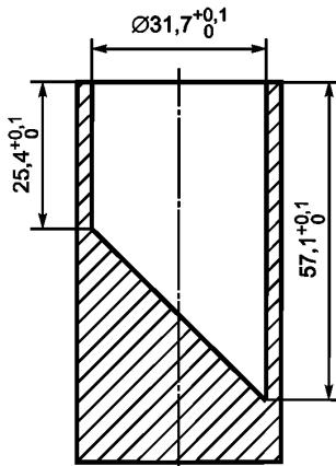
Рисунок 18 — Цилиндр для мелких деталей
