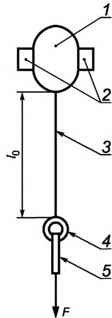
1 — мячик; 2 — неподвижный зажим; 3 — резинка, изготовленная из упругого материала; 4 — кольцо или другая деталь, изготовленная из упругого материала; 5 — крюк;  $l_0$  — расстояние между мячиком и кольцом
