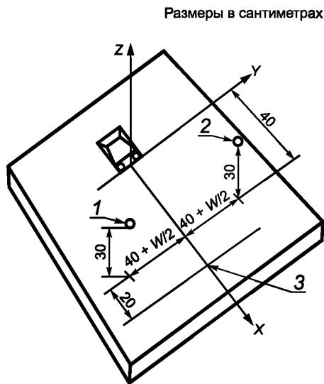
Рисунок 35 — Положения микрофонов для измерения игрушек тяни-толкай
