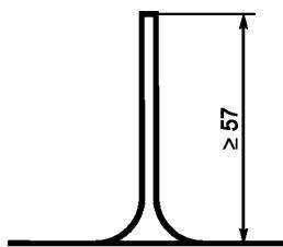
Рисунок 13 — Измерение длины снаряда с *вакуумной присоской*
