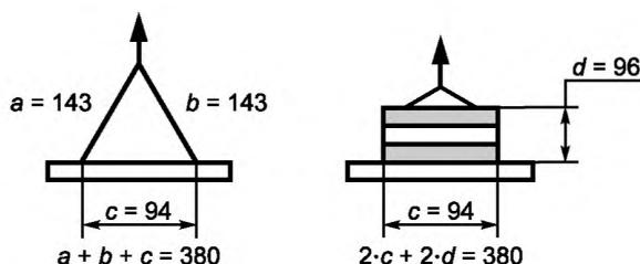
Рисунок А.2 — Пример для одного и того же *шнура* на одной и той же игрушке, измерения для которой проводились двумя различными методами
