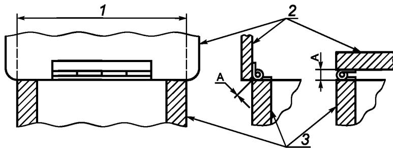
1 — линия шарнира; 2 — крышка; 3 — ящик; А — расстояние между краями деталей, соединенных шарниром
