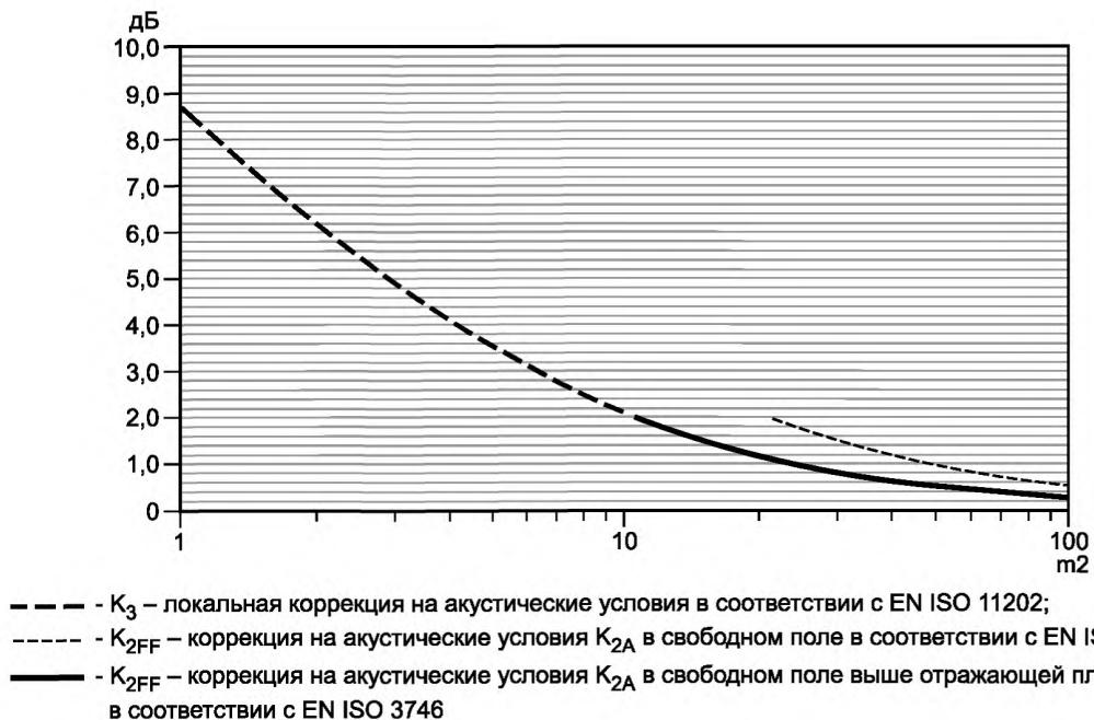
Рисунок 32 — Коррекция на акустические условия как функция эквивалентной площади звукопоглощения режима испытаний
