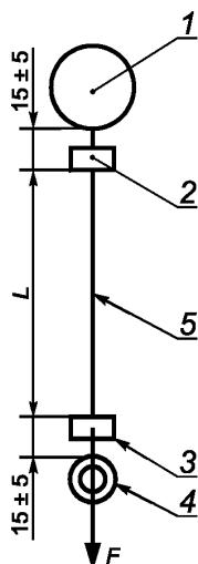
1 — мячик; 2 — неподвижный зажим; 3 — свободно перемещаемый зажим; 4 — кольцо или другая деталь, изготовленная из упругого материала; 5 — резинка, изготовленная из упругого материала;  $L$  — расстояние между двумя зажимами
