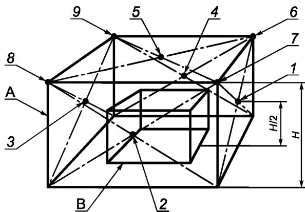
*A — измерительная поверхность; B — огибающий параллелепипед; 1—5 — основные положения микрофонов; 6—9 — дополнительные положения микрофонов для крупногабаритных игрушек; H — высота измерительной поверхности*
