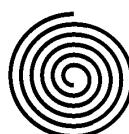
Рисунок 5 — Спиральная пружина
