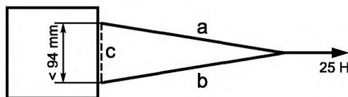
Рисунок 43 — Измерение с точками крепления менее 94 мм
