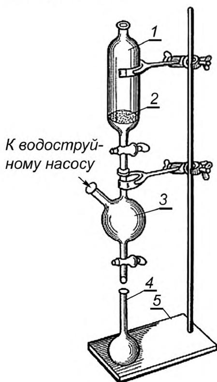
1 — фильтрующая делительная воронка; 2 — стеклянный влянный фильтр № 2 или 3; 3 — приемник; 4 — мерная колба вместимостью 50 см<sup>3</sup>; 5 — штатив
