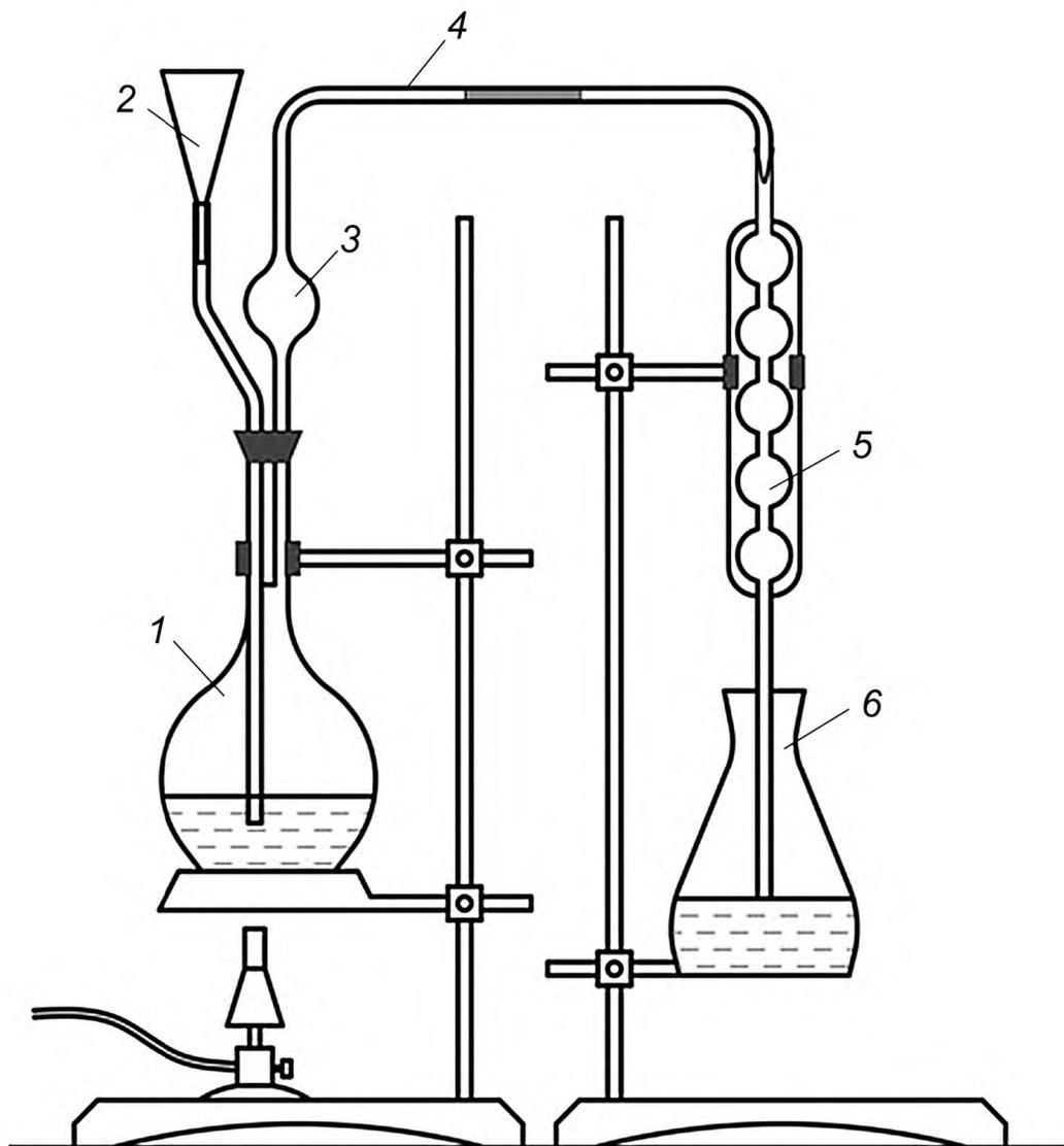
1 — плоскодонная колба; 2 — воронка для внесения раствора; 3 — каплеуловитель; 4 — соединительная трубка;
