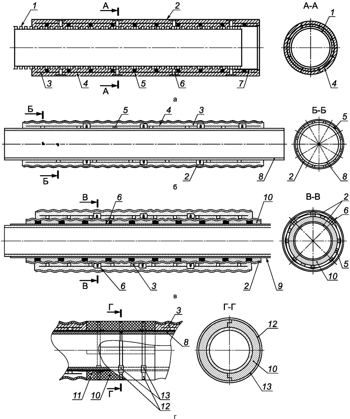
а — труба из полипропилена гофрированная; б — труба стальная (полиэтиленовая); в — труба стальная с тепловой изоляцией; г — стык труб с заливкой пенополиуретаном; 1 — гофрированная двухслойная полипропиленовая труба; 2 — металлополимерная оболочка; 3 — защитное бетонное покрытие; 4 — арматурный каркас; 5 — фиксатор арматурного каркаса; 6 — центрирующая опора; 7 — раструб; 8 — полиэтиленовая труба; 9 — эпоксидное покрытие; 10 — пенополиуретан; 11 — термоусадочная лента; 12 — оболочка; 13 — замок
