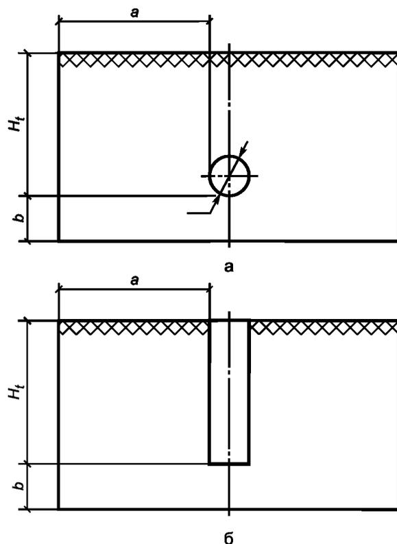
$a$  — расстояние в плане между краем выработки и вертикальной границей расчетной области;  $b$  — расстояние по высоте между низом выработки и нижней границей расчетной области;  $H_s, H_t$  — глубины заложения низа открытой и закрытой выработок соответственно;  $D_s$  — диаметр или поперечный размер закрытой выработки
