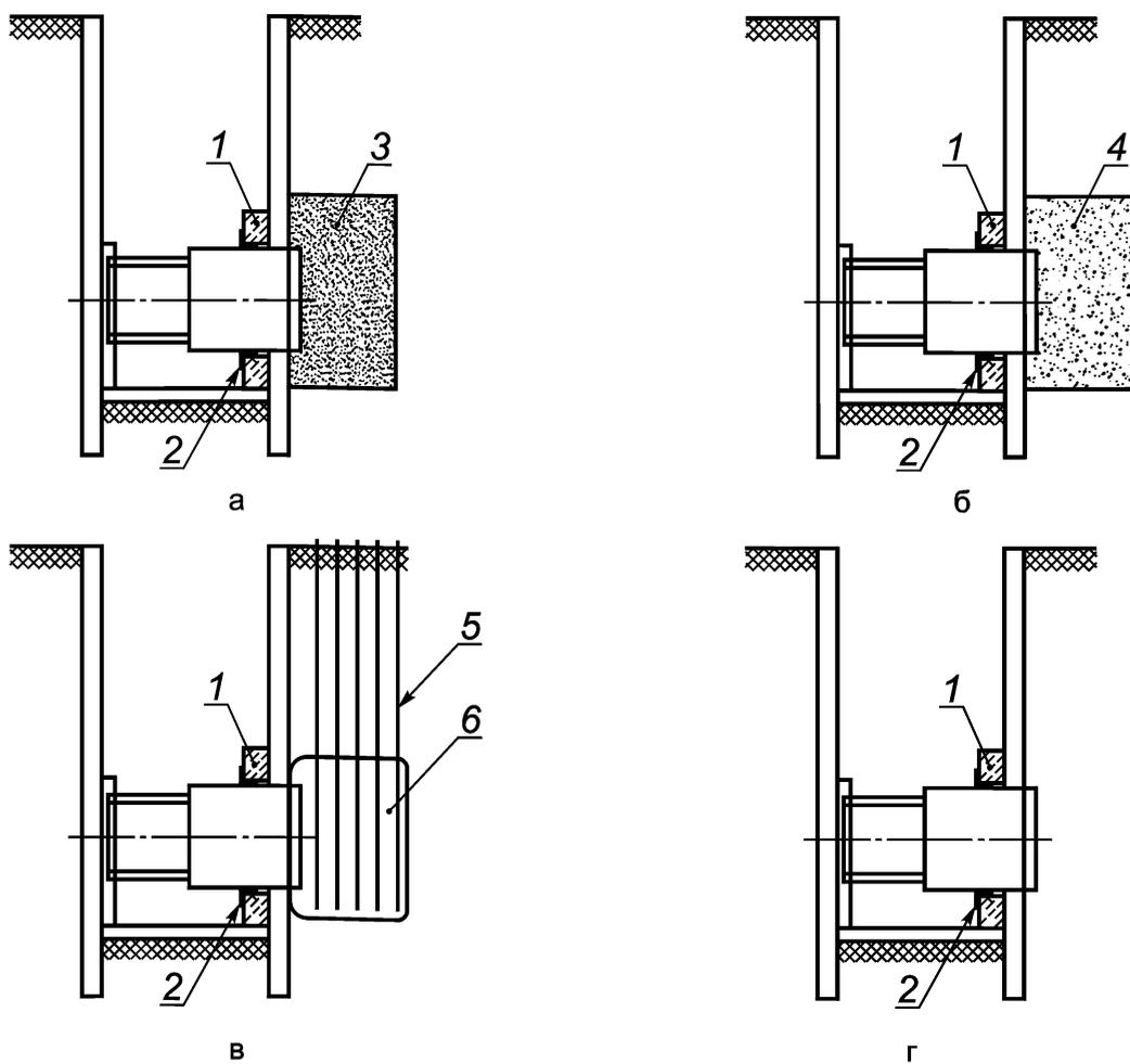
а — метод химического закрепления грунта; б — метод струйной цементации; в — метод замораживания грунтов; г — метод вырезания специальной стенки; 1 — бетонное обрамление выхода; 2 — выходное уплотнение; 3 — закрепленная зона; 4 — зона замещенного грунта; 5 — замораживающие трубы; 6 — зона замороженного грунта
