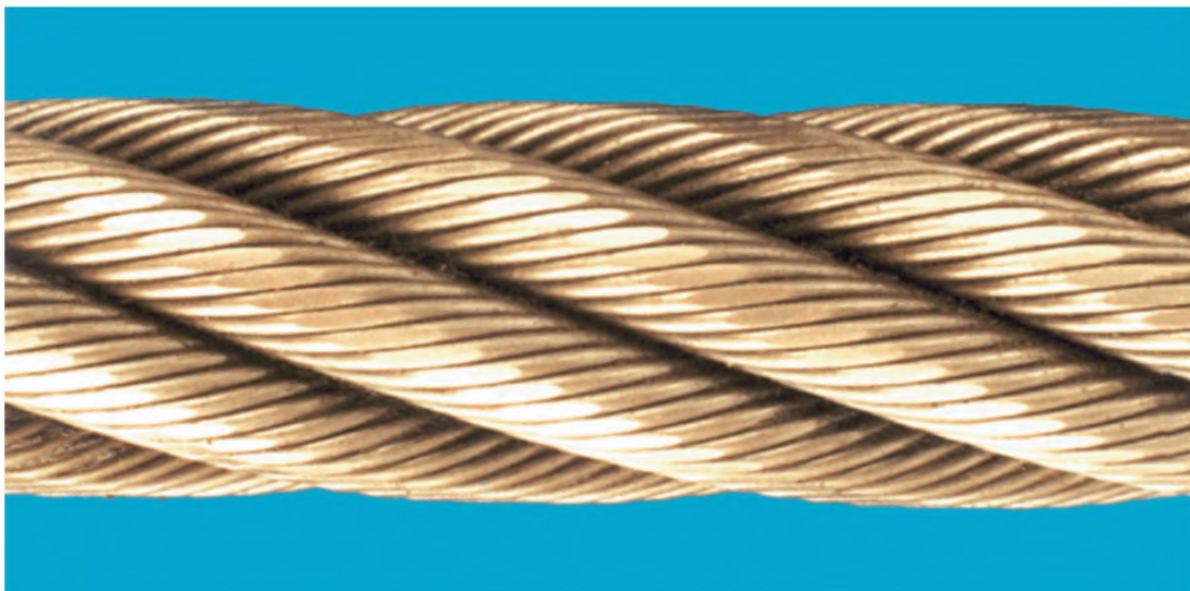
Рисунок А.10 — Износ наружных проволочек
