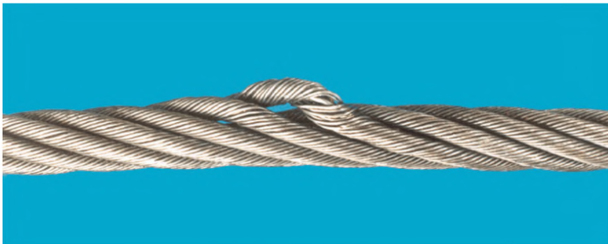
Рисунок А.4 — Выдавливание пряди
