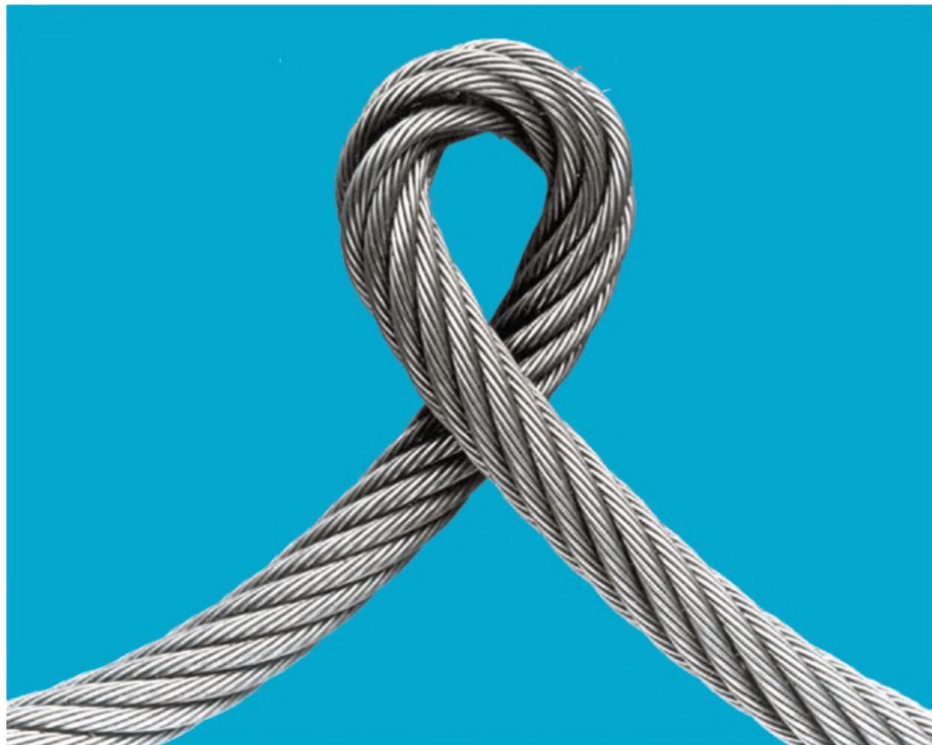
Рисунок А.17 — Перегиб каната
