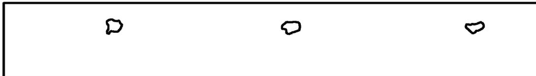
c — пример 3: три дефекта размером 4,0 мм
