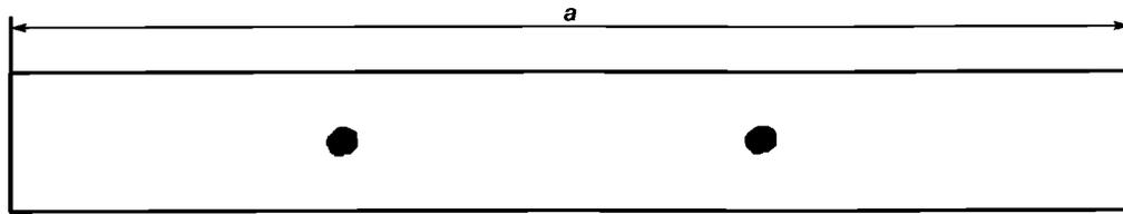
*a* — пример 1: два дефекта размером 3,0 мм
