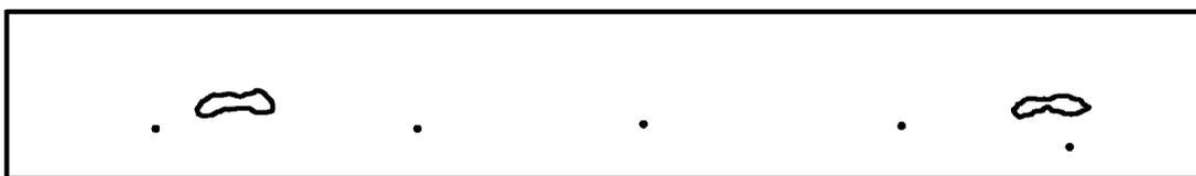
b — пример 2: два дефекта размером 6,0 мм
