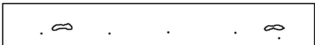
b — пример 2: два дефекта размером 6,0 мм
