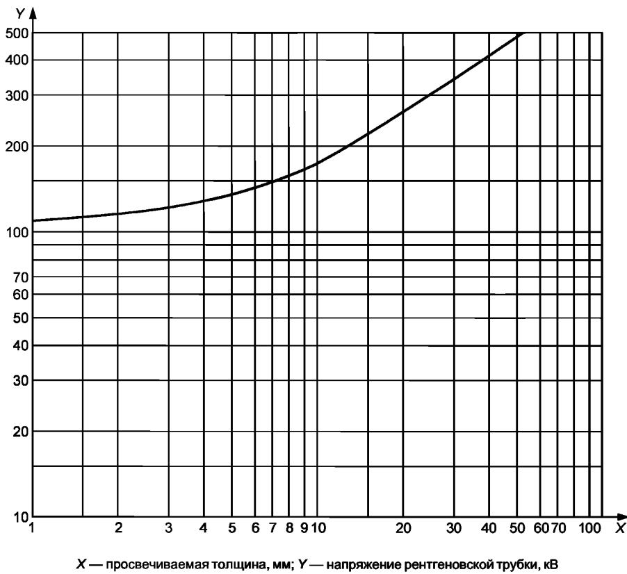
Рисунок 2 — Максимальное напряжение рентгеновской трубы для рентгеновских аппаратов мощностью до 500 кВ как функция от просвечиваемой толщины
