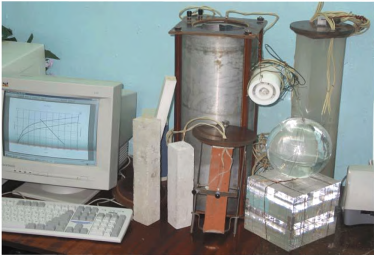
Рисунок 18 – Определение температуропроводности красного кирпича контактным методом Чернышова-Фокина
