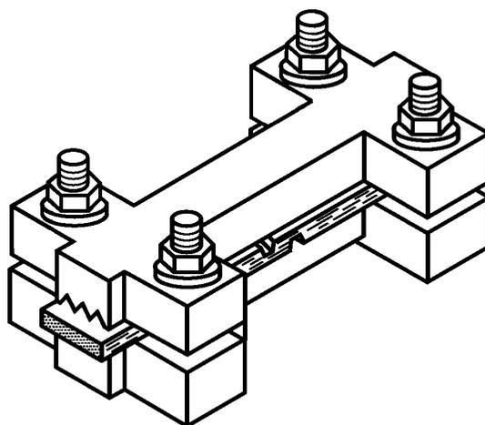
Рисунок 1 — Зажимное приспособление
