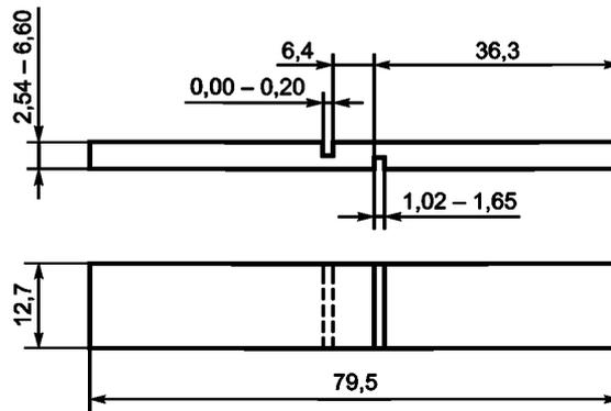
Рисунок 2 — Эскиз образца
