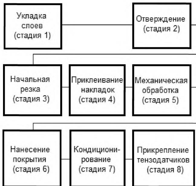
Рисунок 1 — Процесс изготовления образцов для испытания
