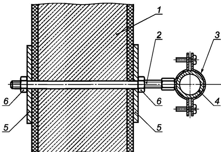
1 — испытательная стена; 2 — металлическая шпилька М10; 3 — металлический хомут со сварочной гайкой, оцинкованный, без изоляции; 4 — испытательный трубопровод; 5 — стальная пластина толщиной  $(6 \pm 1)$  мм, площадью  $(100 \pm 20)$  см<sup>2</sup>; 6 — гайка М10
