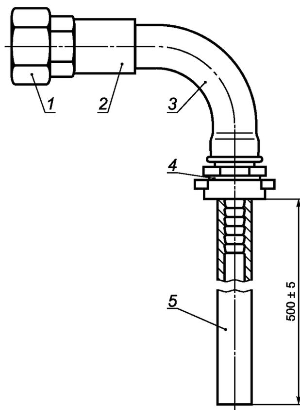
1 — оцинкованная соединительная муфта с конусным гнездом типа U11-1 [2]; 2 — собранное в соответствии с рисунком 5 ОУШ; 3 — оцинкованный коленчатый патрубок G4-¾ [2] с двусторонней внутренней и односторонней наружной резьбой; 4 — соединительная муфта R ¾, с резьбой по [3], с латунной хвостовой частью для гибкого рукава внутренним диаметром 13 мм; 5 — гибкий рукав внутренним диаметром (13 ± 0,5) мм и толщиной стенки (3 ± 0,3) мм
