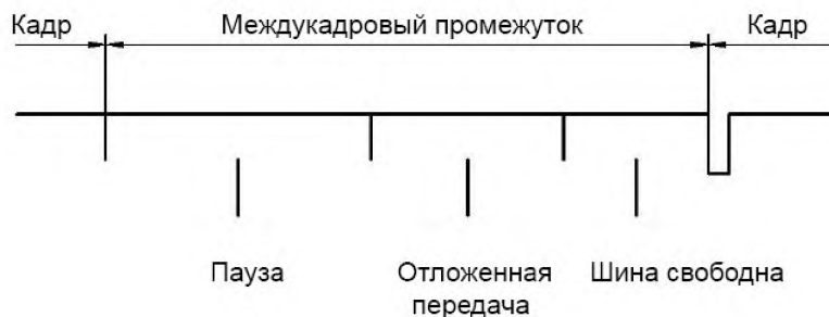
Рисунок 9 — Междукадровые промежутки для узлов, пассивных к ошибкам, которые являлись передатчиками предыдущего кадра
