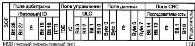
Рисунок 10 — Порядок передачи битов (базовый формат)
