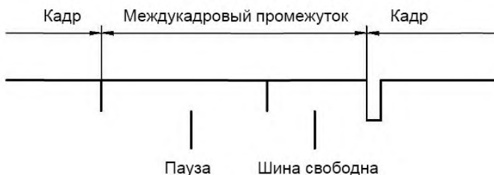
Рисунок 8 — Межкадровые промежутки для узлов, не пассивных к ошибкам, или приемников предыдущего кадра
