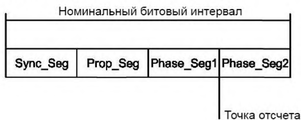
Рисунок 13 — Разделение битового интервала
