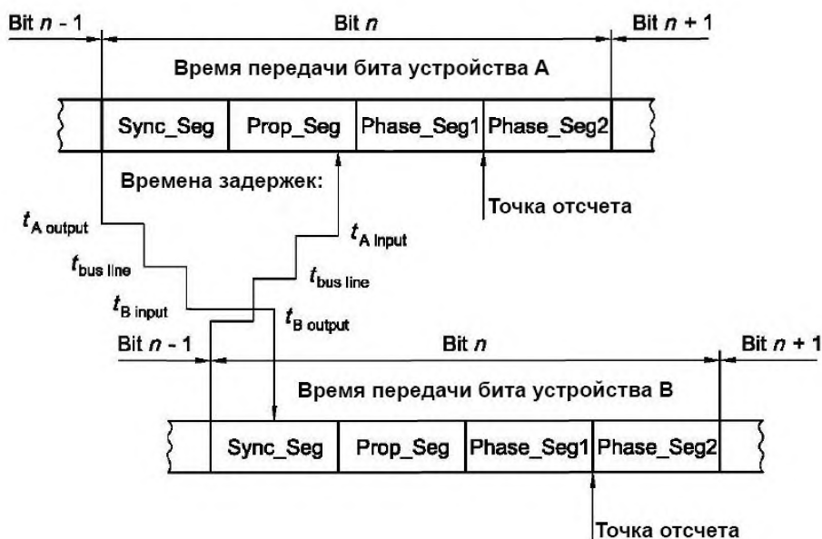
Рисунок 14 — Временные соотношения между временными распределениями узлов CAN А и В во время арбитража, временным распределением двух узлов CAN и временами задержек
