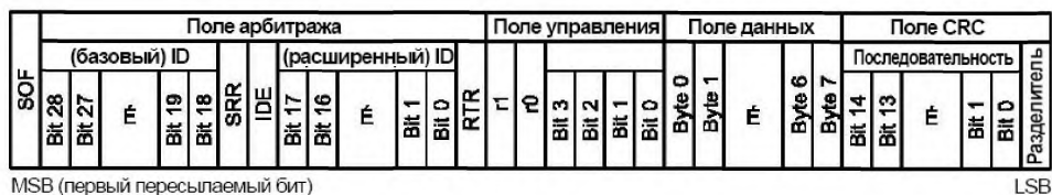
Рисунок 11 — Порядок передачи битов (расширенный формат)
