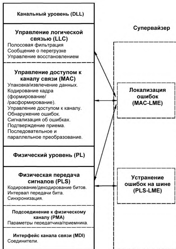
Рисунок 1 — Иерархическая архитектура CAN
