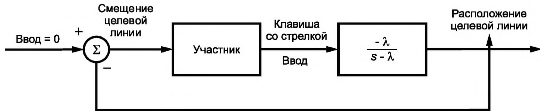
\lambda — уровень неустойчивости или интенсивность расхождения (настраиваемый); s — переменная преобразования Лапласа Рисунок 1 — Блок-схема системы управления
