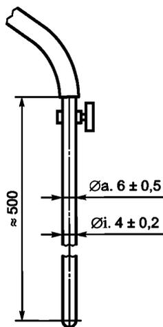
Рисунок 2 — Промывная трубка
