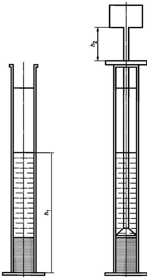
Рисунок 4 — Измерение высот  $h_1$  и  $h_2$
