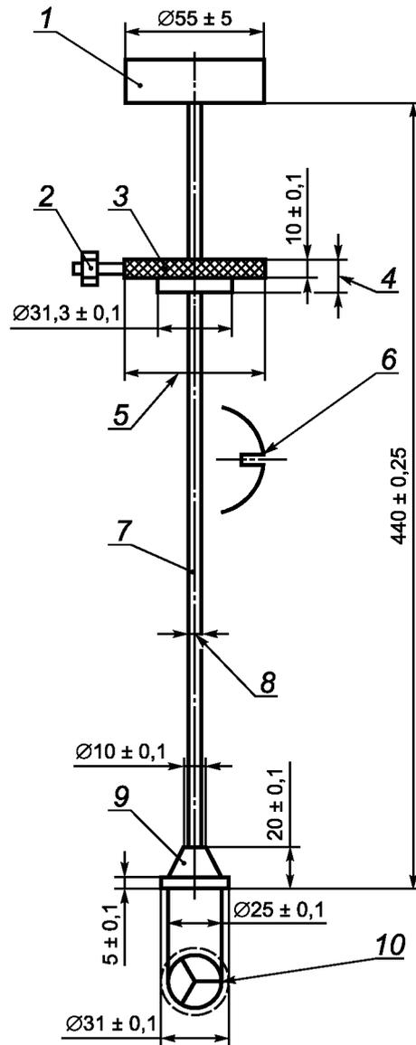
1 — съемная рукоятка; 2 — фиксирующий болт; 3 — манжета; 4 — размер детали равный ( $15,0 \pm 0,5$ ) мм; 5 — внешний диаметр манжеты ( $60,0 \pm 0,5$ ) мм; 6 — паз для линейки; 7 — стержень; 8 — диаметр стержня ( $6,0 \pm 0,1$ ) мм; 9 — наконечник; 10 — направляющие
