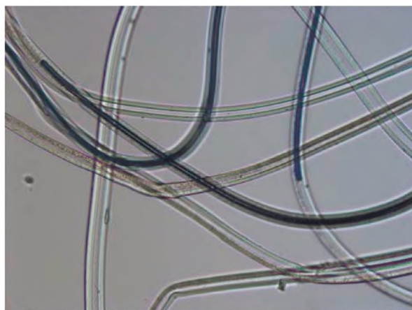
Рисунок В.18 — Полиамид с отверстием: продольный вид
