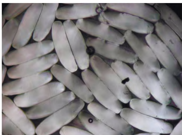
Рисунок В.7 — Эластолефин: поперечное сечение
