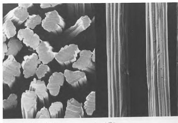
Рисунок С.36 — Триацетат: поперечное сечение и продольный вид
