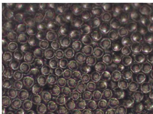
Рисунок 11 — Оптический микроскоп: вид поперечного сечения бикомпонентного полиэфир/ полиэфирного волокна
