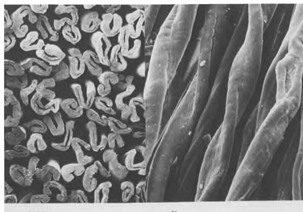
Рисунок С.14 — Хлопок: поперечное сечение и продольный вид
