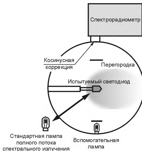
Рисунок 4 — Оптическая схема измерений в режиме полного потока
