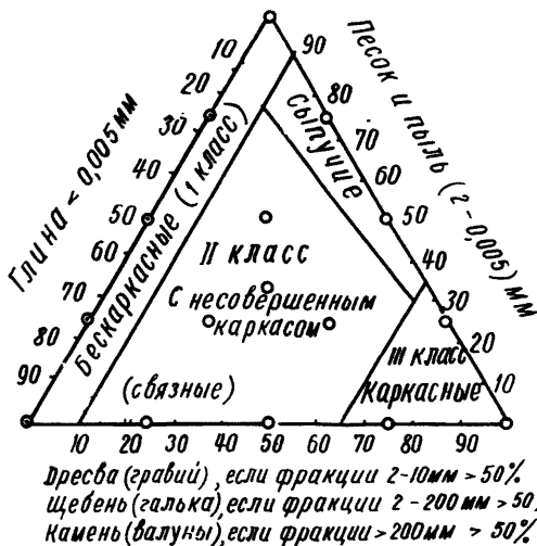
Рис.1. График - треугольник для оценки класса крупнообломочных грунтов по их гранулометрическому составу
