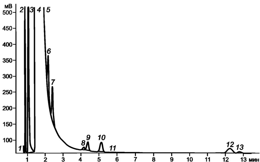
1 — этан; 2 — этилен; 3 — пропан; 4 — пропилен; 5 — изобутан; 6 — *n*-бутан; 7 — пропadiен; 8 — транс-бутилен; 9 — альфа-бутилен; 10 — изобутилен; 11 — цис-бутилен; 12 — метилацетилен; 13 — бутadiен-1,3
