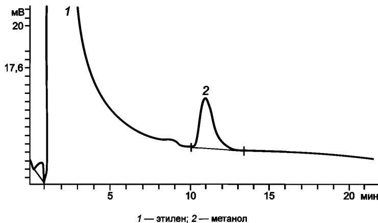
Рисунок 7 — Типовая хроматограмма градуировочной смеси метанола в этилене
