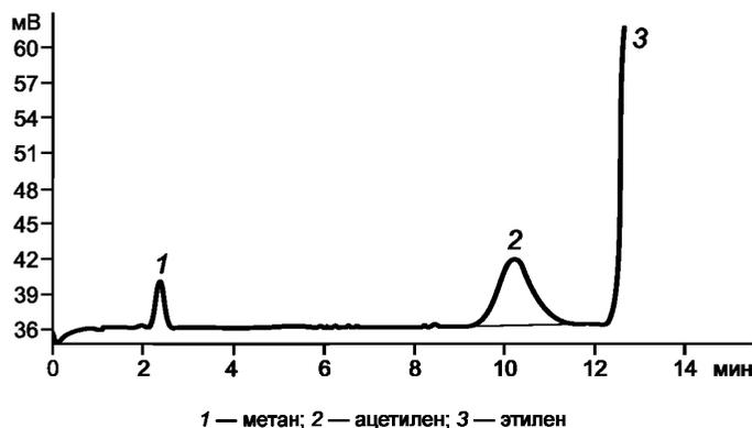
Рисунок 3 — Типовая хроматограмма ацетилен в этилене на колонке с углем СКТ
