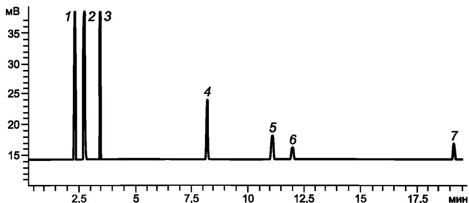
1 — метан; 2 — этан; 3 — этилен; 4 — пропилен; 5 — пропадиен; 6 — ацетилен; 7 — бутадиен-1,3
