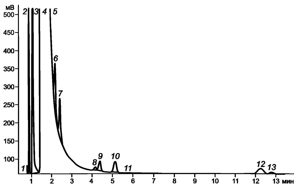
1 — этан; 2 — этилен; 3 — пропан; 4 — пропилен; 5 — изобутан; 6 — *n*-бутан; 7 — пропадиен; 8 — транс-бутилен; 9 — альфа-бутилен; 10 — изобутилен; 11 — цис-бутилен; 12 — метилацетилен; 13 — бутадиен-1,3
