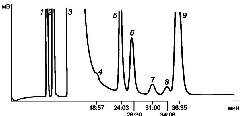
1 — этан; 2 — пропан; 3 — пропилен; 4 — изобутан; 5 — пропадиен; 6 — *n*-бутан; 7 — метилацетилен; 8 — цис-бутилен; 9 — бутадиен-1,3
