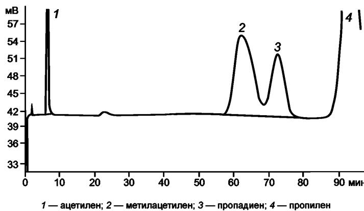
1 — ацетилен; 2 — метилацетилен; 3 — пропадиен; 4 — пропилен
