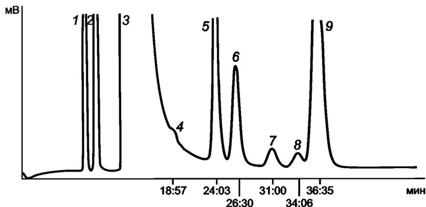
1 — этан; 2 — пропан; 3 — пропилен; 4 — изобутан; 5 — пропадиен; 6 — *n*-бутан; 7 — метилацетилен; 8 — *цис*-бутилен;
