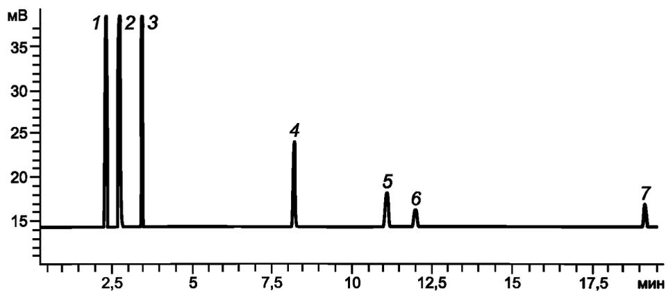
1 — метан; 2 — этан; 3 — этилен; 4 — пропилен; 5 — пропadiен; 6 — ацетилен; 7 — бутadiен-1,3
