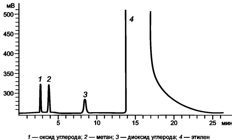
Рисунок 5 — Типовая хроматограмма градуированной смеси оксида и диоксида углерода в этилене на колонке с полисорбом-1
