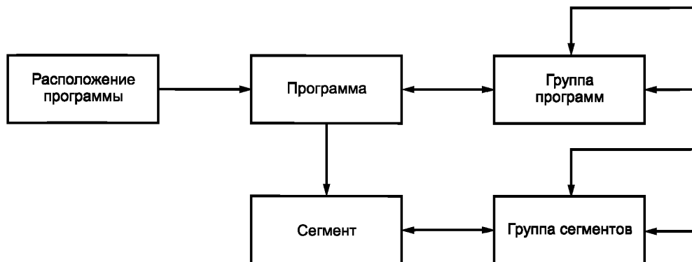
Рисунок 5 — Схема взаимосвязей объектов компонентов сегментированной программы
