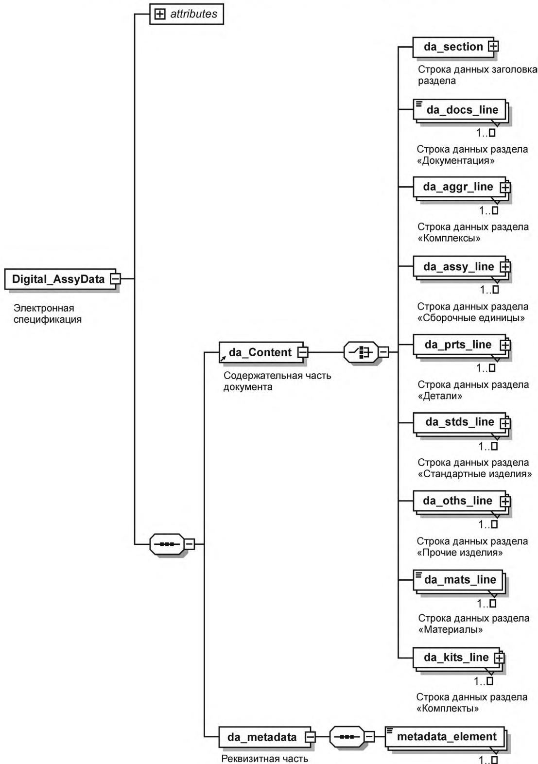
Рисунок Б.1 — Логическая модель данных электронной спецификации
