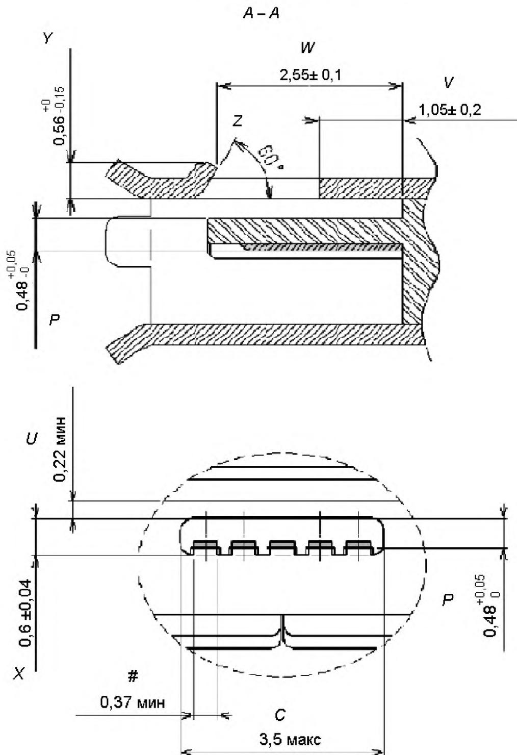
Рисунок В.7.2 — Габаритные размеры USB серии «В» — розетка
