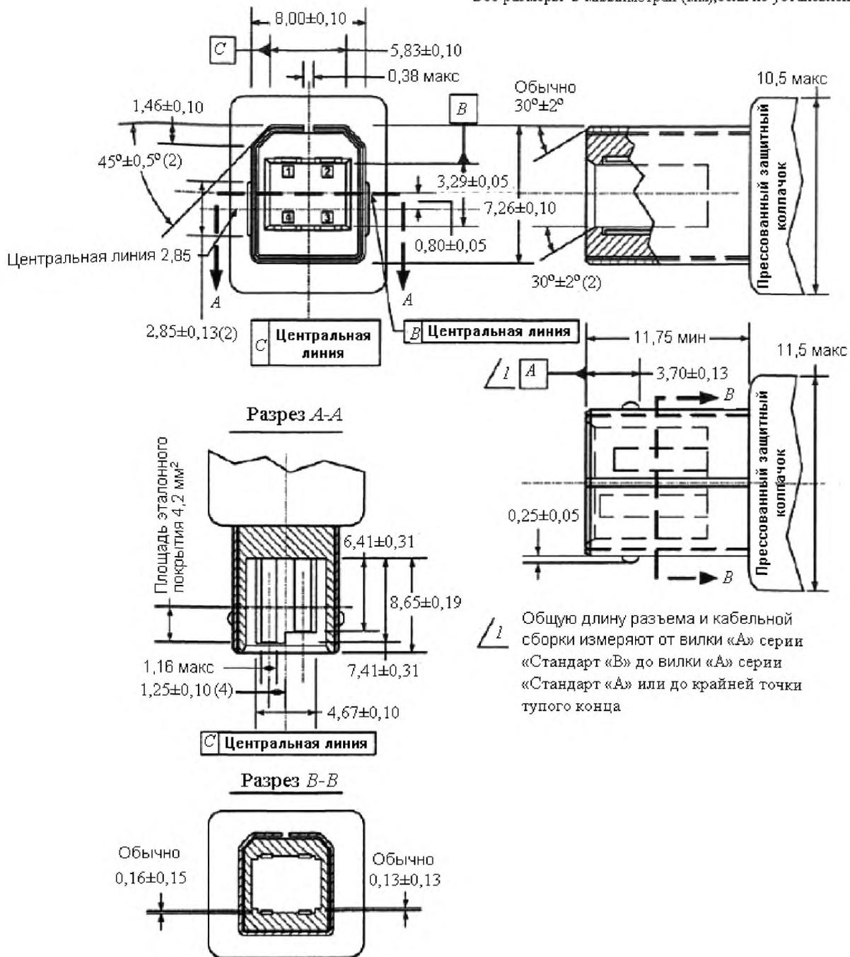
Рисунок В.3 — Габаритные размеры USB серии «Стандарт «В» — вилка
