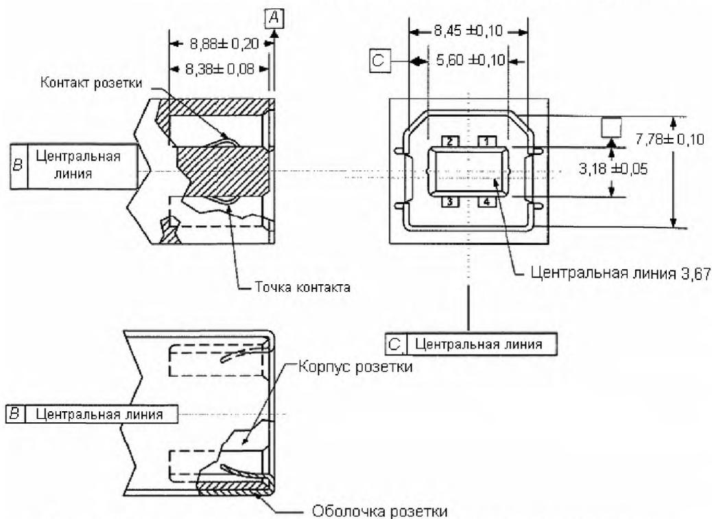
Общий вид соединения USB-розетки и вилки серии «Стандарт «В»
