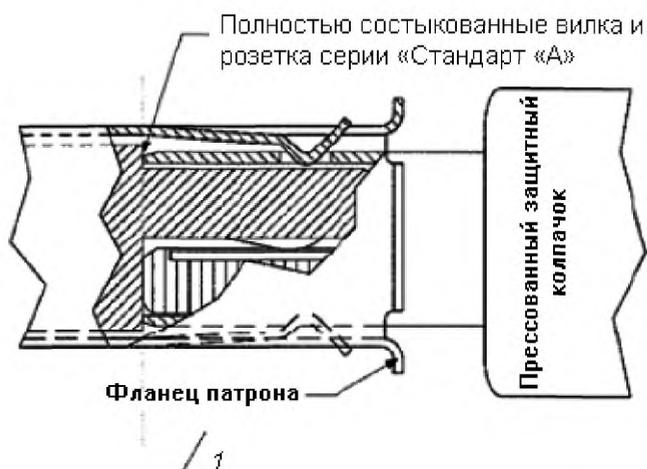
1 Обеспечивается минимальное расстояние 2,67 мм между лицевой частью розетки и защитным колпачком вилки
