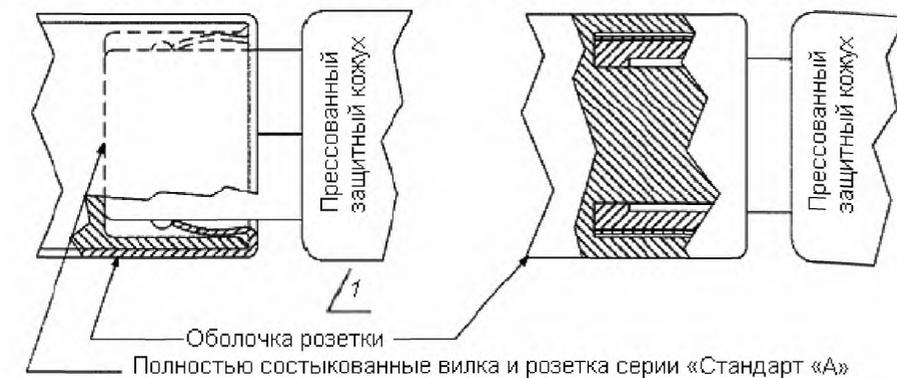
1 Обеспечивается минимальное расстояние 2,67 мм между лицевой частью розетки и защитным колпачком вилки
