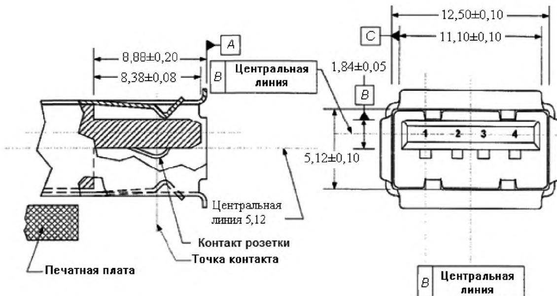
Общий вид соединения USB-розетки и вилки серии «Стандарт «А»
