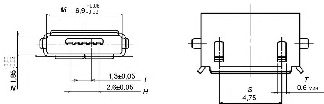
Рисунок В.8.1 — Габаритные размеры USB серии «Микро «АВ» — розетка
