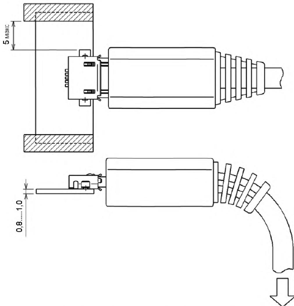
Рисунок D.1 — Размещение USB при проведении испытаний
