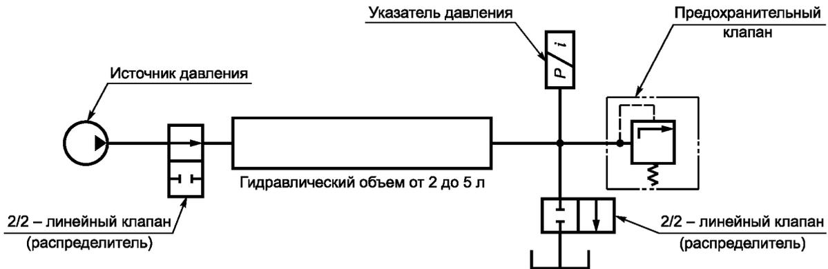
Рисунок А.1 — Схема испытаний (пример)
