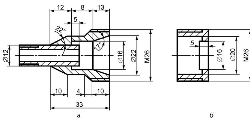
а — корпус; б — накидная гайка
