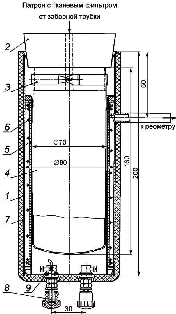
1 — корпус; 2 — резиновая пробка; 3 — хомутик; 4 — фильтровальный мешок; 5 — стакан; 6 — электрообогрев; 7 — тепловая изоляция; 8 — контакты; 9 — текстолитовая втулка
