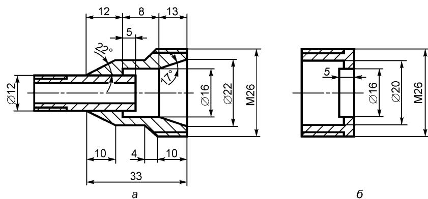
а — корпус; б — накидная гайка
