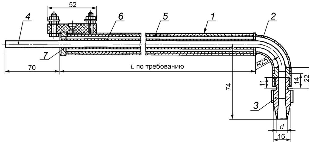
1 — корпус; 2 — шейка; 3 — наконечник; 4 — стальная трубка, диаметр 4 — 6 мм; 5 — нихромовая обмотка; 6 — асбестовая изоляция; 7 — изолирующая шайба
