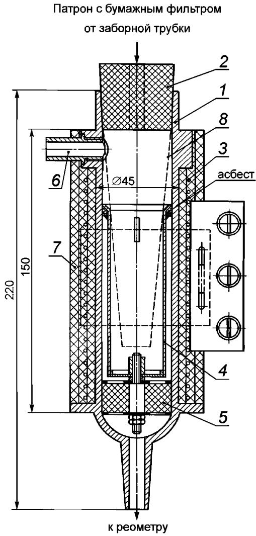
1 — корпус; 2 — резиновая пробка; 3 — электрообогрев; 4 — колпак; 5 — фильтр из асбестовой ваты; 6 — трубка; 7 — тепловая изоляция; 8 — бумажная фильтровальная гильза
