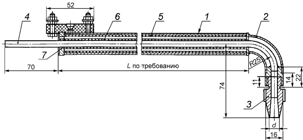
1 — корпус; 2 — шейка; 3 — наконечник; 4 — стальная трубка, диаметр 4 — 6 мм; 5 — никромовая обмотка; 6 — асбестовая изоляция; 7 — изолирующая шайба
