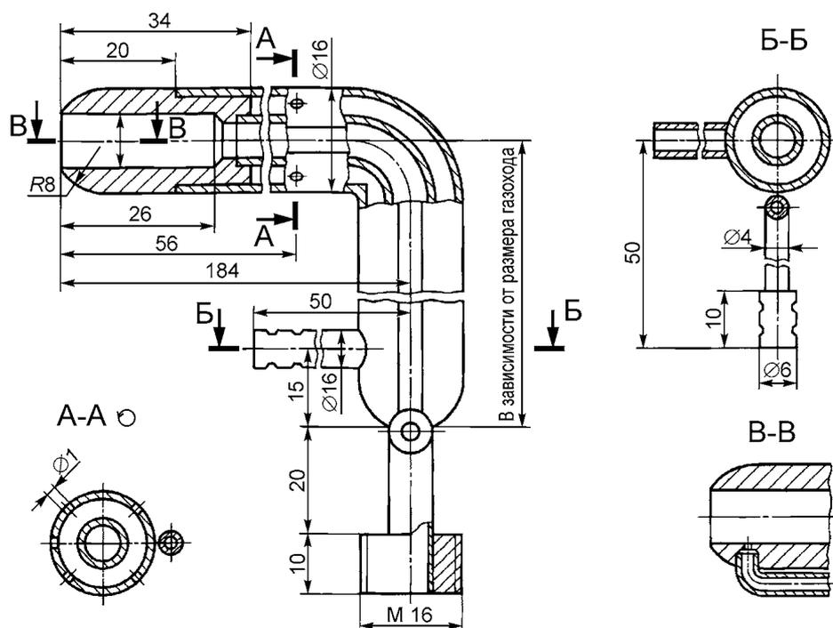
Рисунок А.3 — Пылезаборная трубка нулевого типа
