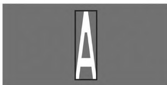
а – для горизонтальной разметки в виде наклонных полос (включая ломаные), ограниченных сплошными одиночными линиями; б – для горизонтальной разметки в виде равнобедренного треугольника, обращенного вершиной к водителю, не окрашенного внутри; в – для горизонтальной разметки в виде изображения буквы «А»
