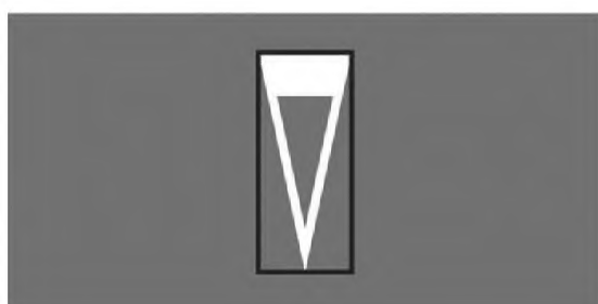
а – для горизонтальной разметки в виде наклонных полос (включая ломаные), ограниченных сплошными одиночными линиями; б – для горизонтальной разметки в виде равнобедренного треугольника, обращенного вершиной к водителю, не окрашенного внутри; в – для горизонтальной разметки в виде изображения буквы «А»
