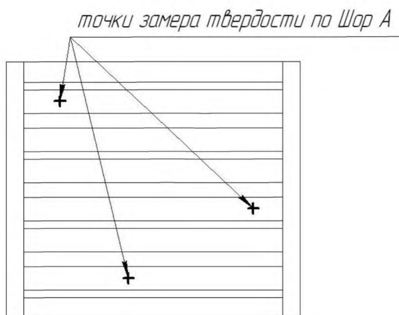
Рисунок 3 — Определение твердости по Шору А
