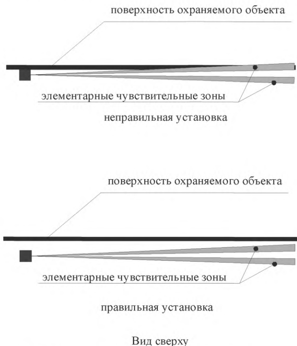
Рисунок 4.15 – Схема установки извещателя вдоль поверхности охраняемого объекта
