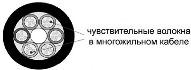
Рисунок 69 - Схема многожильного волоконно-оптического кабеля фирмы FFT
