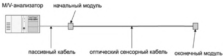
Рисунок 67 - Структурная схема технологии M/V фирмы FFT для обнаружения движения и вибраций волоконно-оптического кабеля
