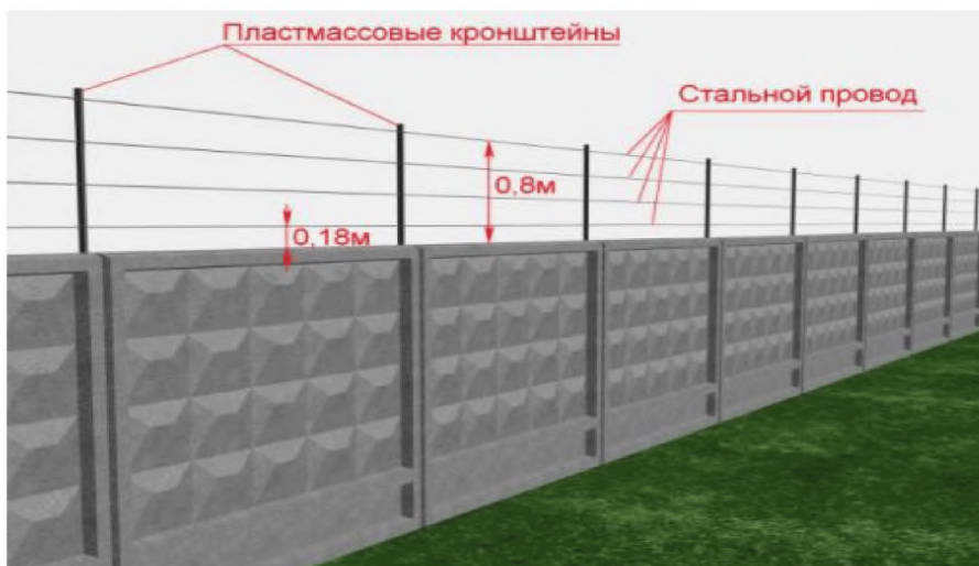
Рисунок 20 – Установка ЧЭ на железобетонном заборе
