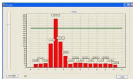
Рисунок 2.88 - Сигналы радара по дистанции
