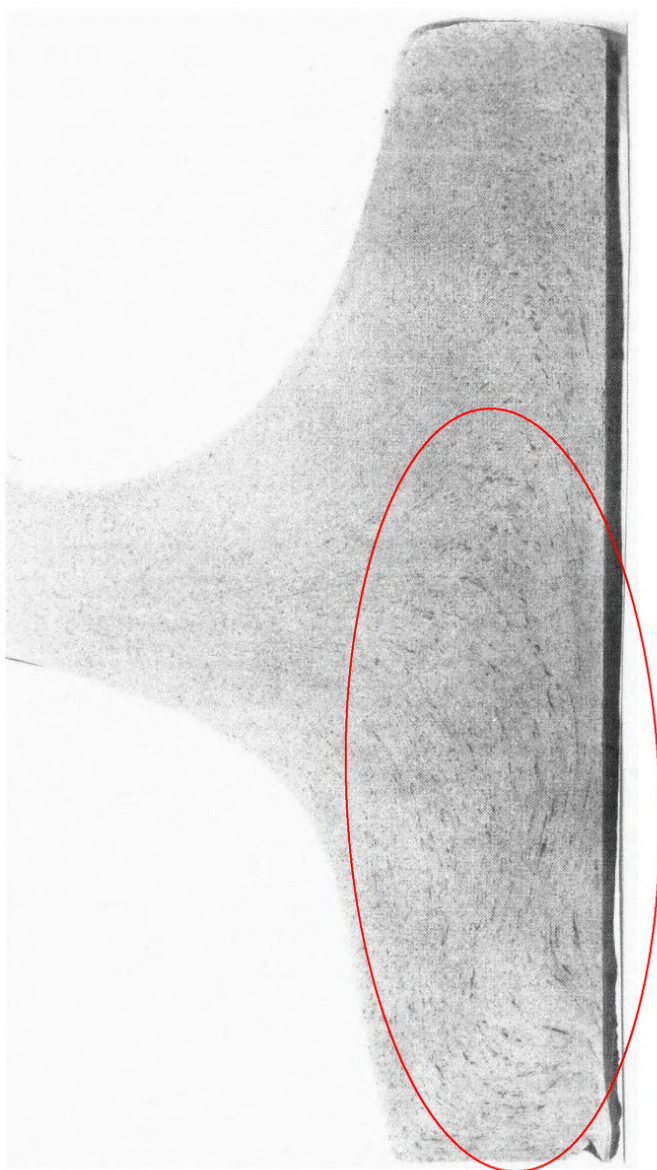
Рисунок Б.21 – Эталон № 21 (ликвационные полосы)
