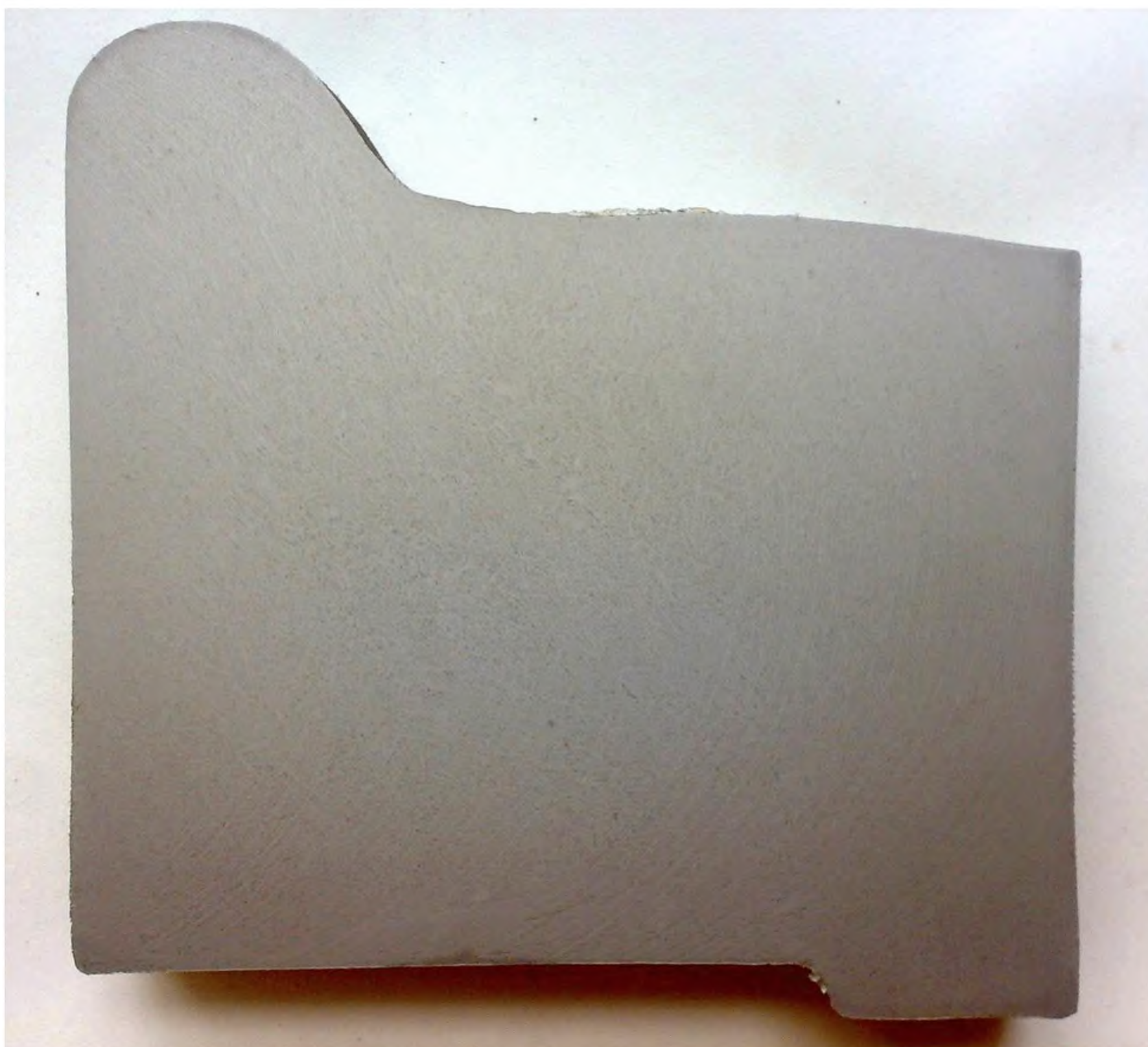
Рисунок А.4 – Эталон № 4 (однородная макроструктура биндажа)
