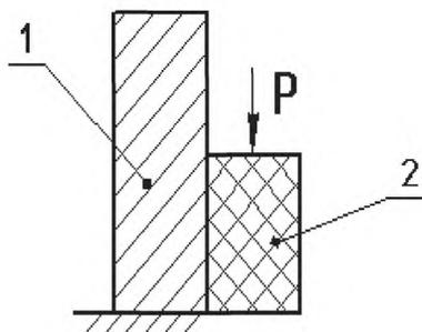
1 – несущая часть; 2 – токосъемная часть;  $P$  – нагрузка
