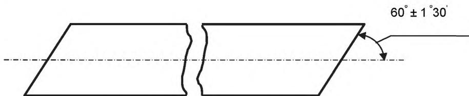
Рисунок 1 – Рабочая поверхность в плане
