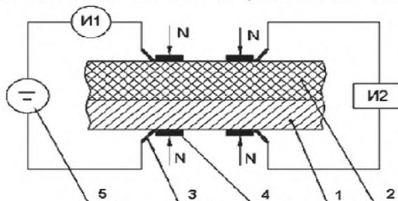
1 – несущая часть или металлическая обойма; 2 – токоъемная (углеродная) часть; 3 – медная пластина – электрод; 4 – изолятор (гетинакс, электрокартон); 5 – источник постоянного тока; N – прижимные устройства (струбцины) для токовых и потенциальных электродов; И1 – амперметр; И2 – милливольтметр
