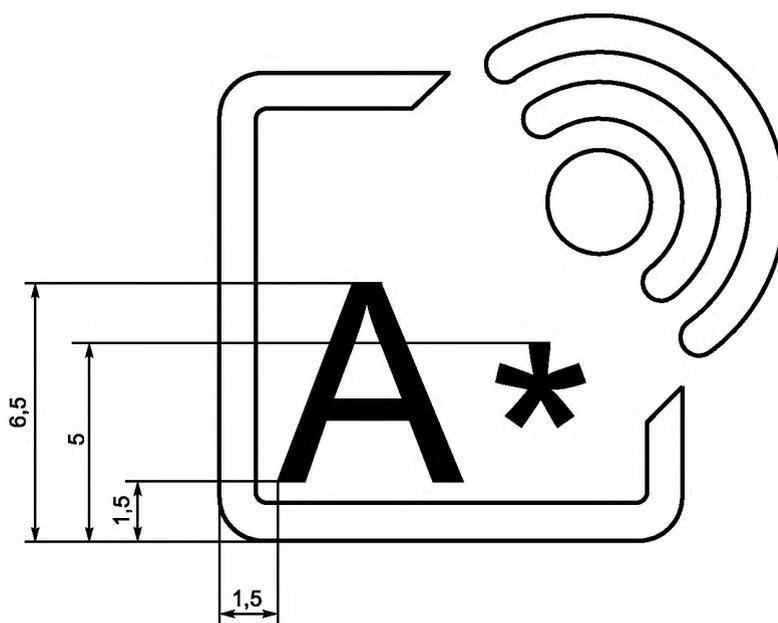
Рисунок В.5 — Эмблема радиочастотной идентификации с кодом для устройства опроса
